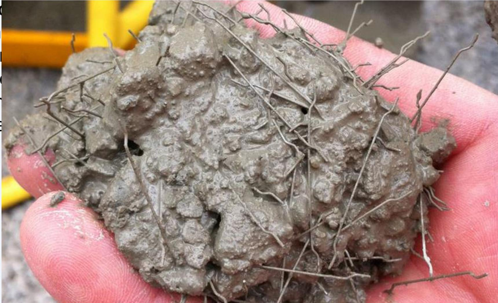
En la mezcla de mortero y sus fibras se mezclan para mejorar la producción.
